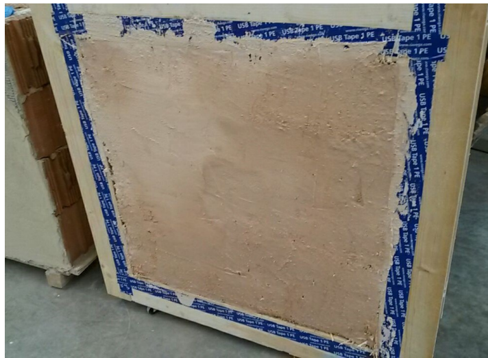
Fig. 1 Immagine del provino prima dell'introduzione nella camera per l'esecuzione delle misure
